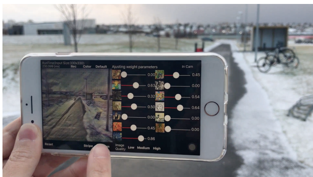
図 5: multi-style feed-forward network を用いたアプリの動作例。画面右側のスライダーを動かすことで任意の重みでスタイルを合成し、リアルタイムに変換可能である。
